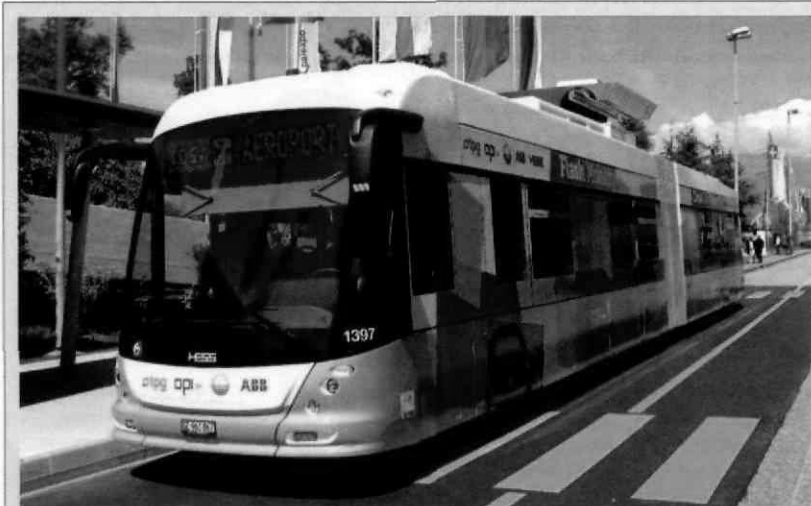
Le Tosa se recharge aux arrêts de bus grâce à son bras articulé.
